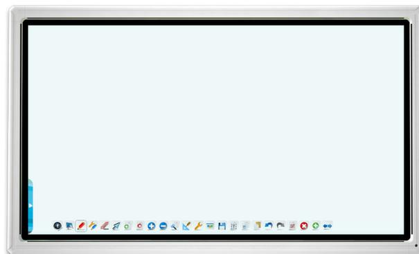
TRIUMPH BOARD 84" MULTI Touch LED LCD 4K Android – это полностью интегрированный профессиональный жидкокристаллический с технологией „мультикасания“ и разрешением 4K/2K. Технология инфракрасных светодиодов делает возможным управление касанием шести пальцами одновременно; кроме того, три/шесть пользователей могут одновременно вводить текст и рисовать как пальцами, так и пером или даже указкой (в зависимости от используемого программного обеспечения).
