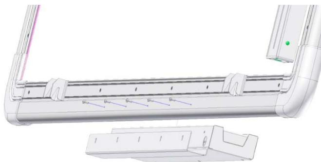
Если у Вас имеется более старая модель интерактивной доски «TRIUMPH BOARD RESISTIVE», то может случиться, что отверстия на задней нижней части рамы отсутствуют. В таком случае следует сначала высверлить отверстия 2,5 мм в раме таблицы согласно расположению отверстий на пассивной полке, а затем прикрепить полку.
