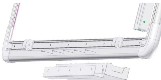
Pokud vlastníte starší model TRIUMPH BOARD RESISTIVE interaktivní tabule, může se stát, že na ní nebudou předvrтанé díry na zadní spodní části rámu. V tom případě, nejdřív předvrtejte 2,5mm díry do rámu tabule podle umístnění děr na pasívní poličce a pak poličku připevněte.
