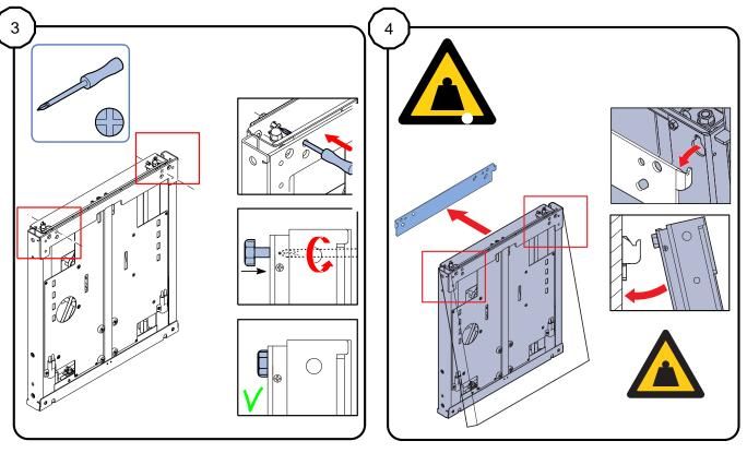
MAKE SURE SCREWS ARE UNLOCKED LIFT LIFTBOX ONTO THE BRACKET
