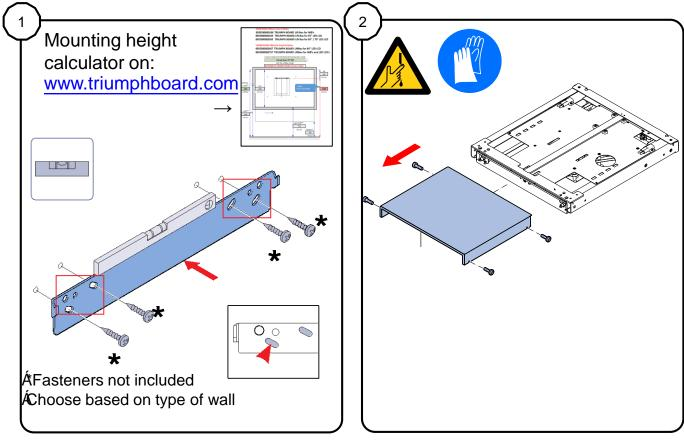
MOUNT WALL BRACKET LEVEL TO THE WALL
