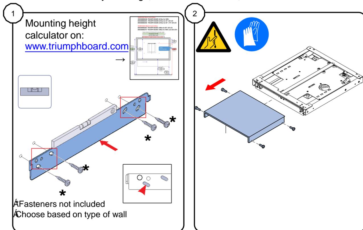
1 MOUNT WALL BRACKET LEVEL TO THE WALL
